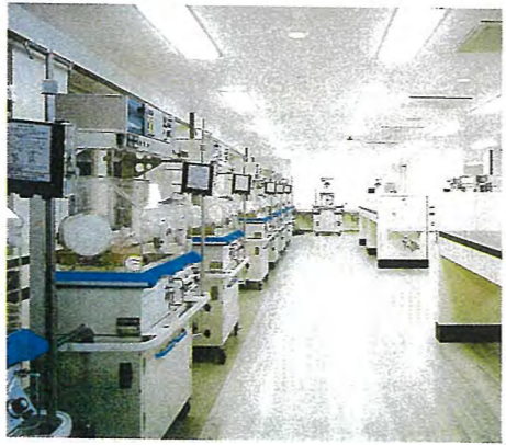
NICUの高度空調(順天堂伊豆長岡病院)地域一次医療の核として配置された新生児センターのNICU。高性能フィルターユニットで天井面から吹き、床付近で還気。
